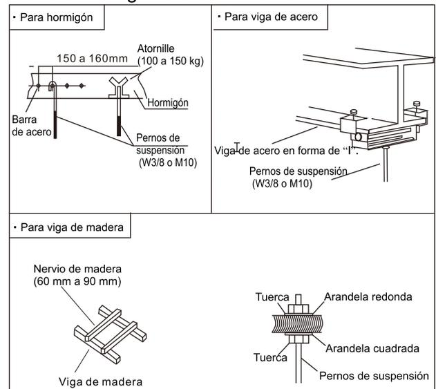
Fig. 3.2.1 Fijar los pernos de suspensión
