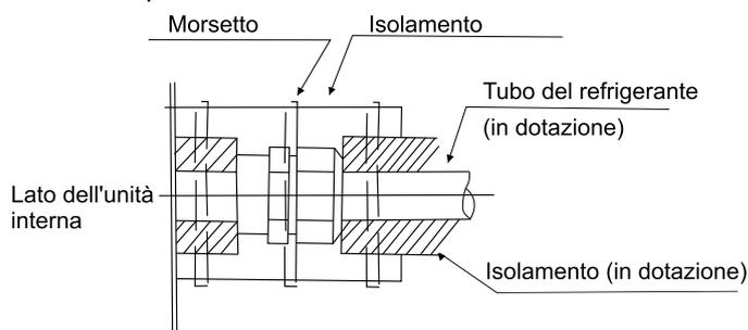
Fig 4.4 Procedura di isolamento dei tubi
