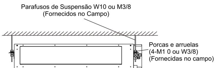
Fig. 3.4 Instalação da unidade interior
