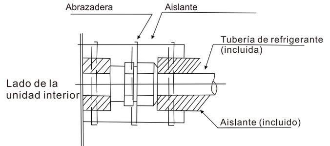
Fig. 4.3 Procedimiento de aislamiento de tuberías
