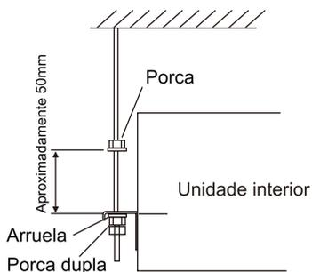
Fig. 3.5 Parafusos e porcas de suspensão
