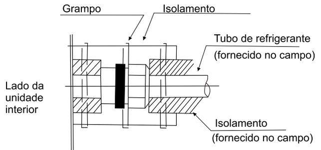
Fig. 4. 3 Procedimento de isolamento da tubagem
