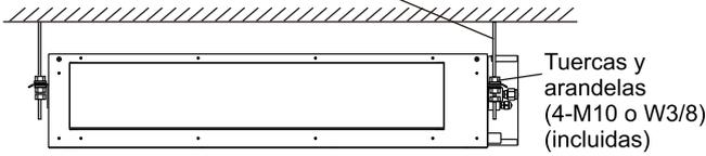
Fig. 3.4 Instalación de la unidad interior
