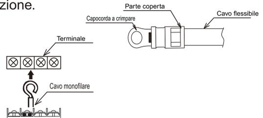
Quando si collega la morsettiera utilizzando un unico filo centrale, assicurarsi di fissarla saldamente.
