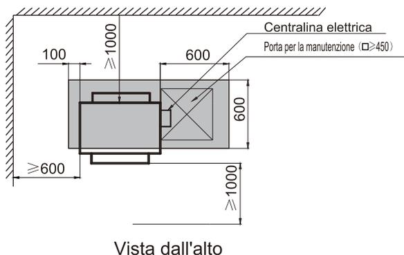
1. Fornire la porta per la manutenzione necessaria quando il soffitto non è rimovibile.
